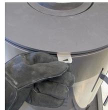
3. Nach dem Anzünden des Papiers/der Anzündwürfel die Feuertür leicht anlehnen, sodass sich bei einer spaltbreiten Öffnung von ca. 5-10 cm gute Zugverhältnisse bilden können.
