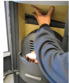
3. Sobald der erste Seitenstein aus dem Ofen ausgebaut ist, kann das Trennelement angehoben und ausgebaut werden.
