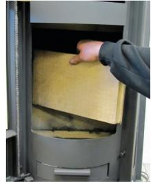
6. Der Rückstein kann jetzt bei Bedarf ausgebaut werden.
